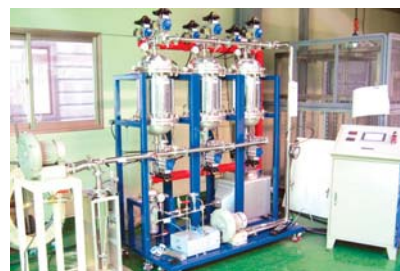
▲ 现代起亚汽车喷漆工厂 VOCs 回收用 VSA (Pilot Test 设备)
